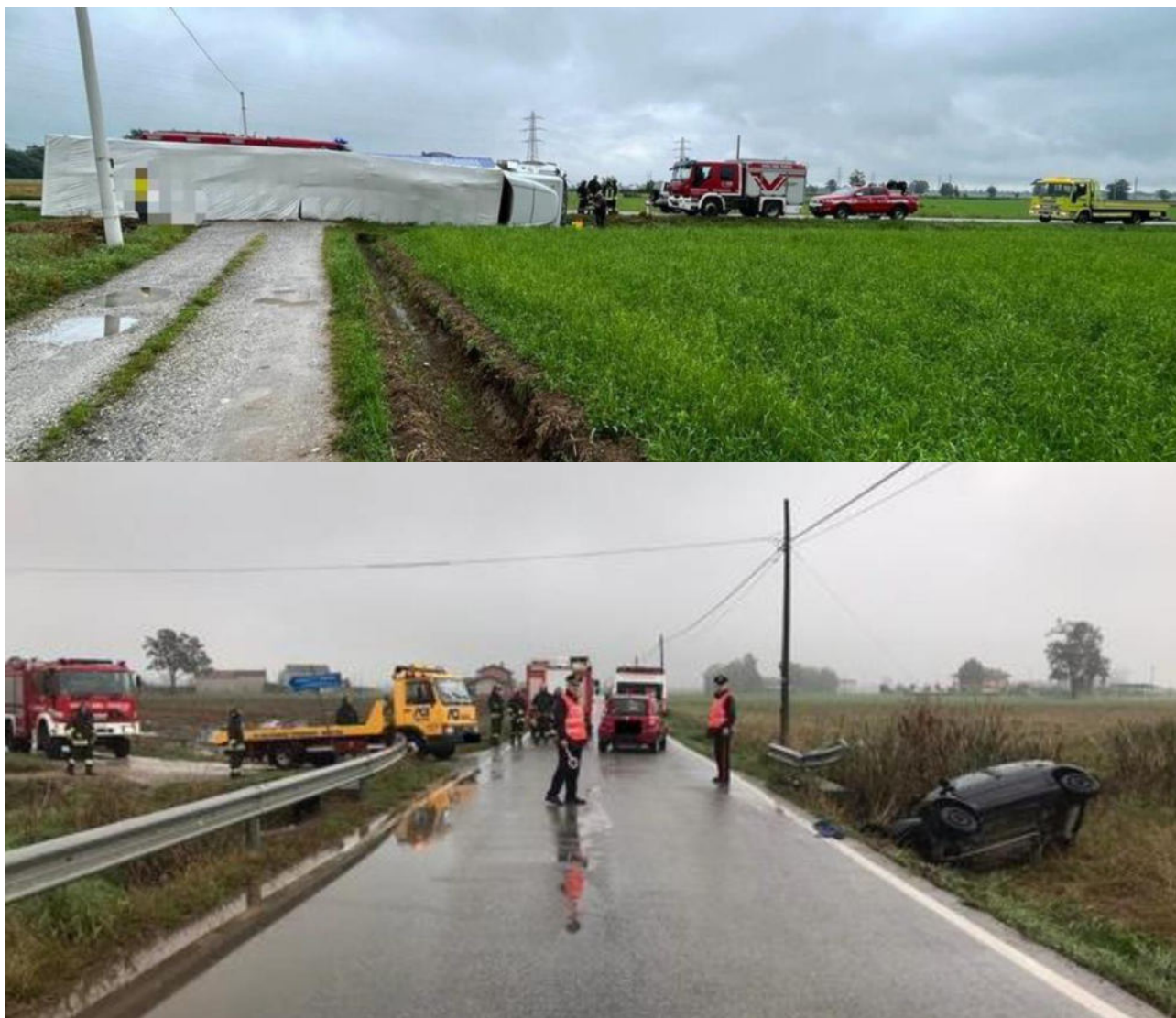
Figura 5.34 - Esempi di incidentalità registrate lungo la SP43: scontro tra veicoli e ribaltamento di autoarticolati per ristrettezza della carreggiata stradale
